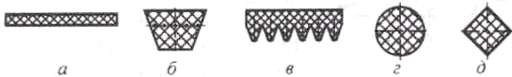
Рис. 9.13. - Сечения ремней
